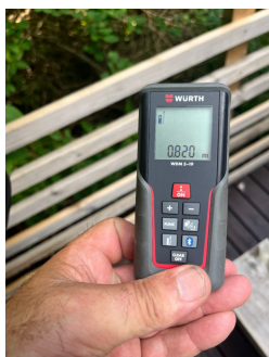
Høyde rekkverk på terrasse 82 cm
