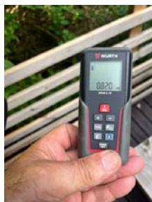
Høyde rekkverk på terrasse 82 cm
