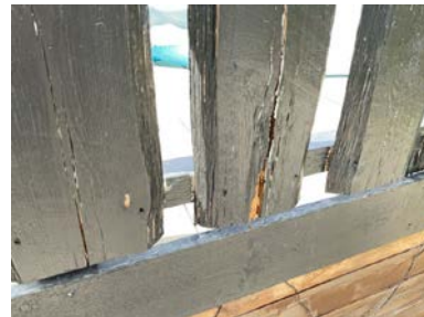
Råteskader på blomsterkasser.
