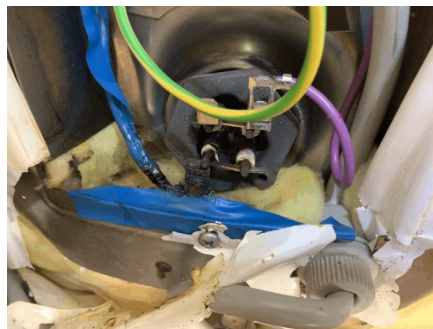
Bildet viser svidd tilkobling.
