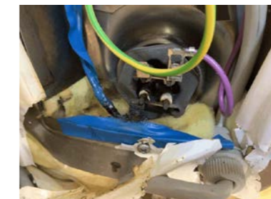
Bildet viser svidd tilkobling.
