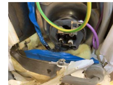
Bildet viser svidd tilkobling.
