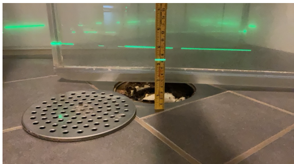
Målt fall til sluk: 31mm
