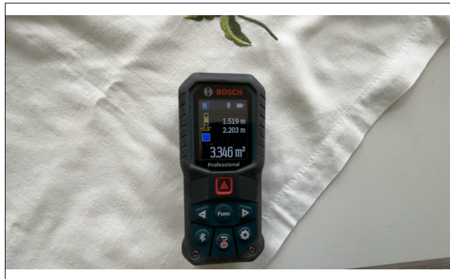
Arealmåling av utebod.
