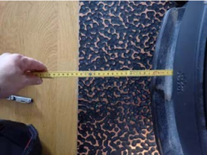
Måles ca. 23 cm avstand til fremkant av plate på gulv foran ovn. Kravet er 30 cm.
