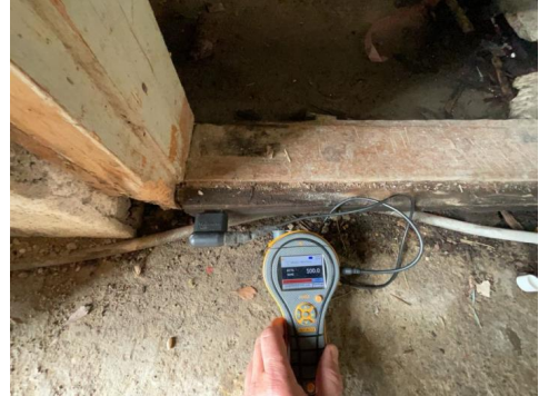
Kontroll av dørterskel mellom lagerrom. Måling viser 100% fuktighet
