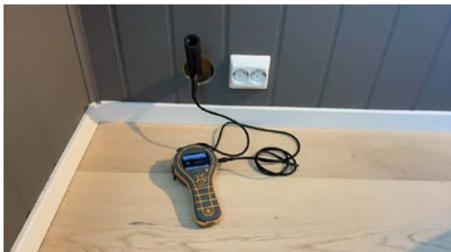
Hulltaking utført fra tilstøtende rom.
