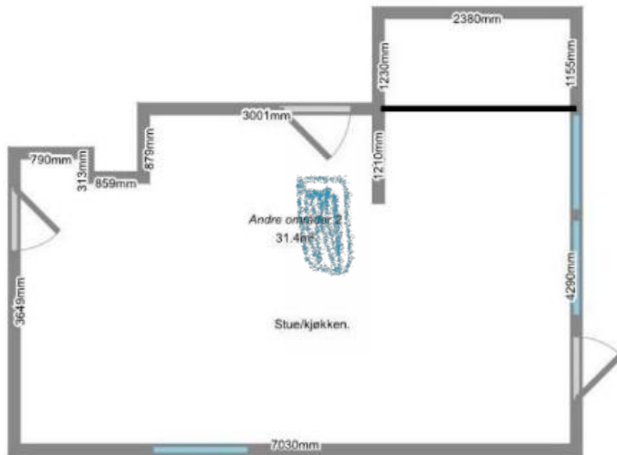
Planskisse stue/kjøkken 1 etg. Blå markering viser hvor himling er skadet.
