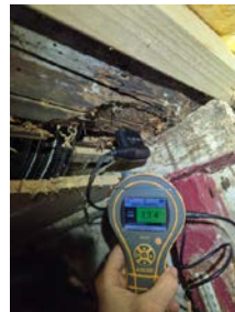
Det er målt fuktinnhold i treverk på 13,4 vektprosent, som anses som tørt, men ligger i øvre sjikt.
