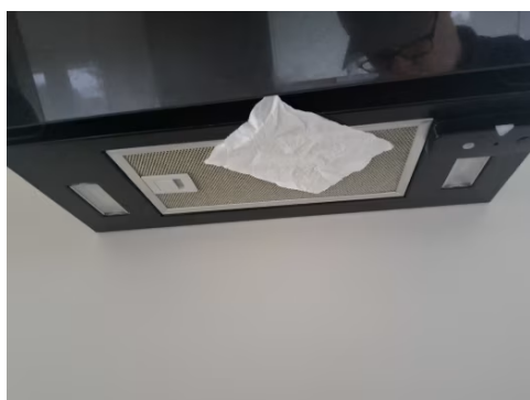
Kjøkkkenventilator er testet med papir.
