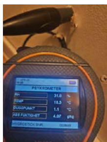
Måling av relativ luftfuktighet i veggkonstruksjon mellom bod og bad
