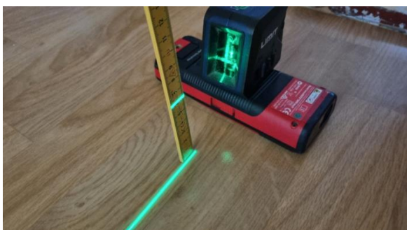
Kontroll av planavvik.
