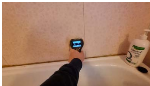
Ingen unormale fuktverdier ble registrert.
