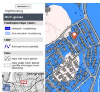
Kloppsteinveien 10 ligger innenfor Marin grense og mulighet for marin leire
