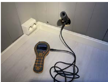
Hulltaking utført fra tilstøtende rom.
