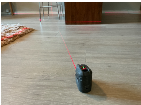
Nivellering stue/kjøkken, avvik ca. 15-30 mm., samt kul på midten.
