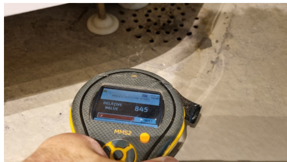
Fuktmåling i gulvet, noe forhøyede fuktverdier ble registrert i gulvet ved sluk.
