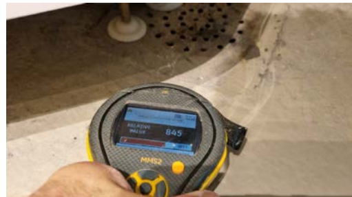
Fuktmåling i gulvet, noe forhøyede fuktverdier ble registrert i gulvet ved sluk.
