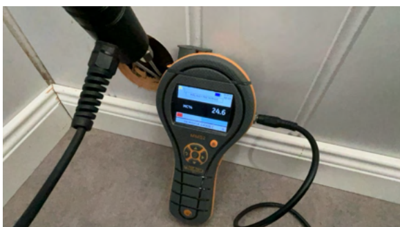
Hulltaking - Fuktmåling i rom under terreng - Skadelig høyt trefuktinnhold i hulltakingsområdet.
