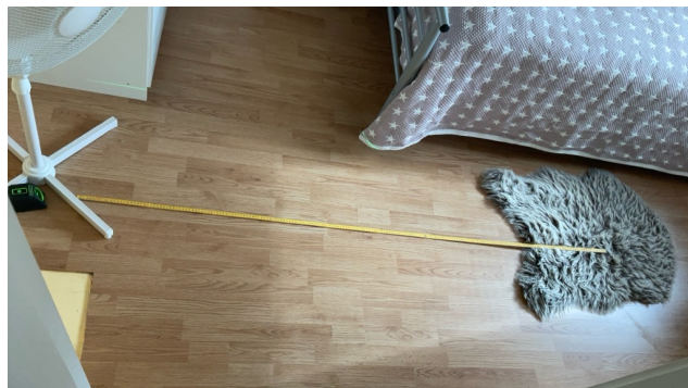
Det er målt ca 1,8cm avvik på høydeforskjeller innenfor 2m.
