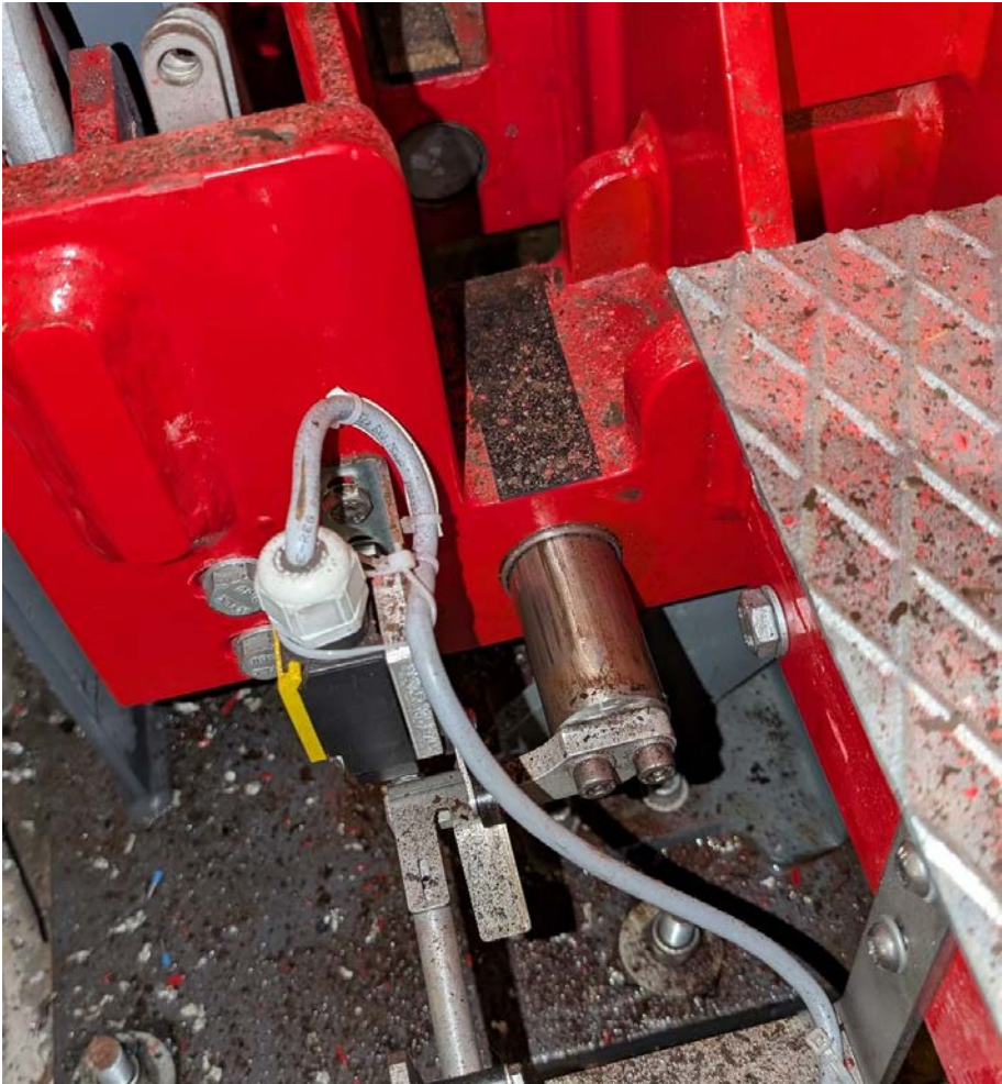
Foto 37: Låsebolt for sikring og henstilling av plattformer i bæring på 4 punkter
