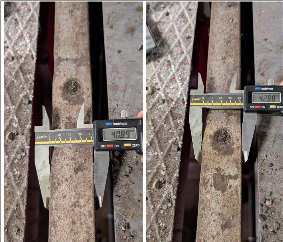
Foto 47: Bredere skinne ved lokal deformasjon rundt bolteforbindelse til skinne
