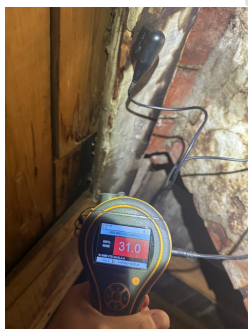
Det er påvist fukt-/råteskader i takkonstruksjonen.
