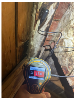
Det er påvist fukt-/råteskader i takkonstruksjonen.
