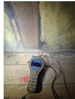
Målt vektprosent under 6% som er tørt tre.
