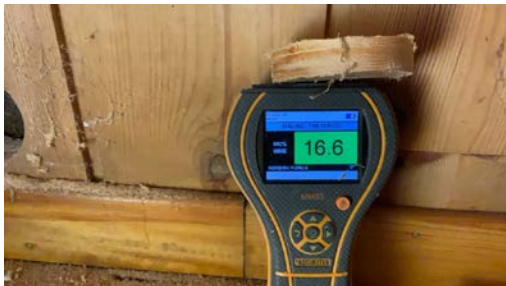
Fuktmåling i panel mot yttervegg.
