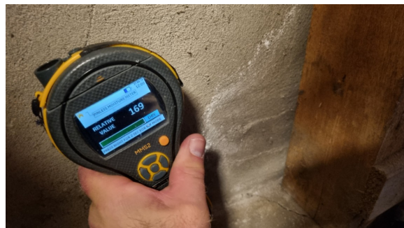
Fuktmåling direkte på betongyttervegg på flere steder. Ingen unormale fuktverdier ble registrert,
