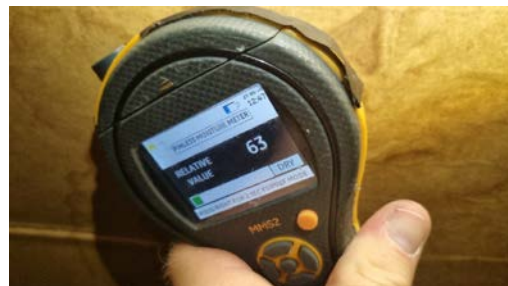
Fuktmåling på kaldloftet, ingen unormale fuktverdier ble registrert.
