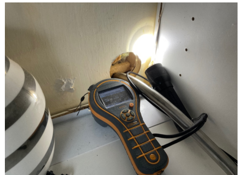
Hulltaking i kjøkkenskap mot innebygget sisterner
