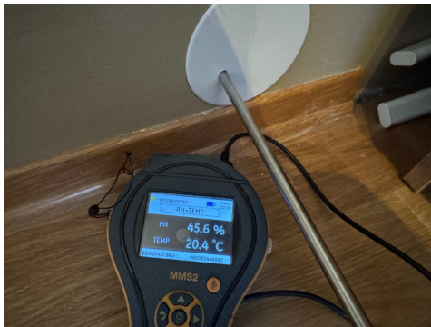
Måling av relativ luftfuktighet.
