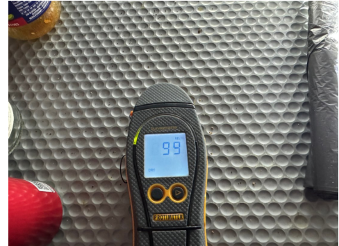
Ingen forhøyede fuktverdier ble registrert i kjøkkenbenken.
