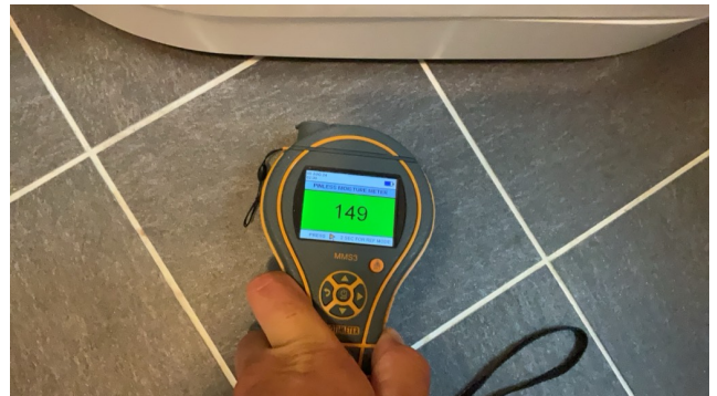
Ved overflatesøk på gulv var det ikke fuktutslag
