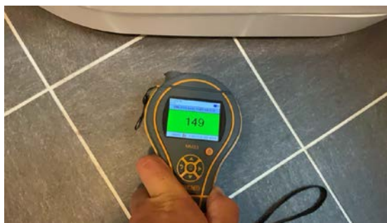
Ved overflatesøk på gulv var det ikke fuktutslag
