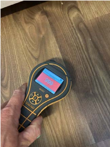
Fuktsøk ved oppvaskmaskin.
