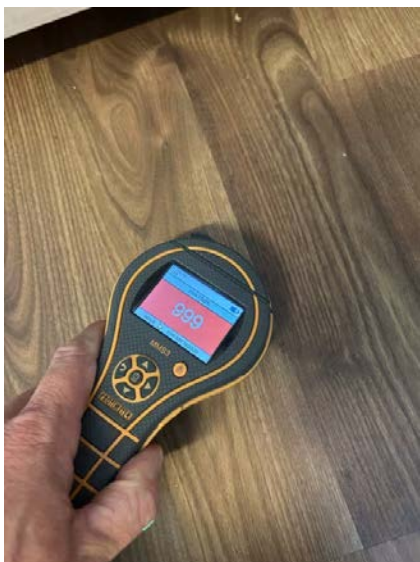
Fuktsøk ved oppvaskmaskin.
