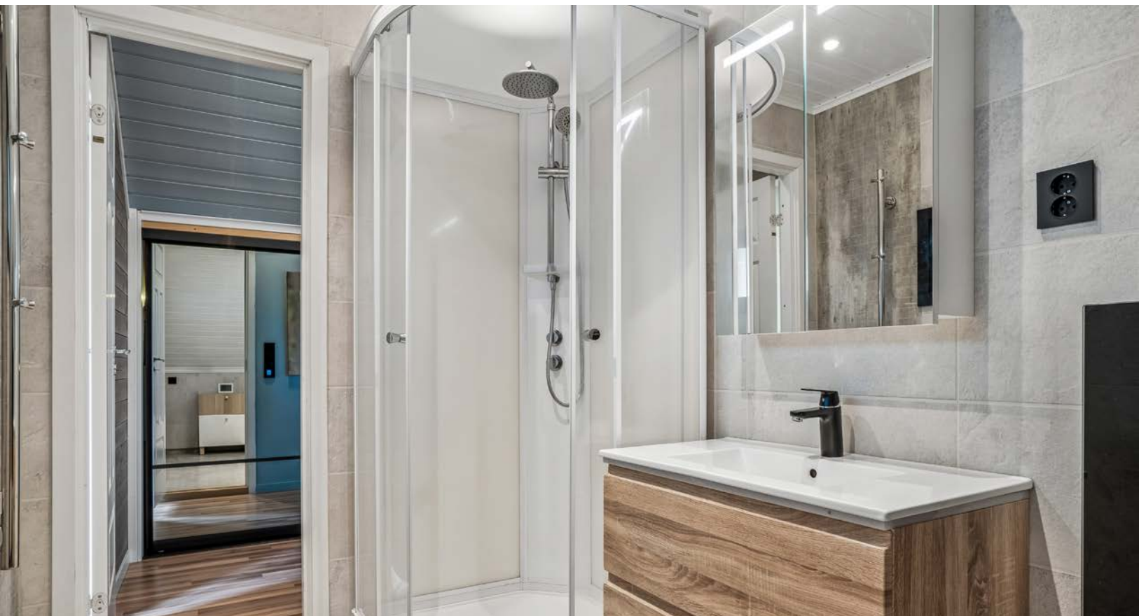
Rommet har vinylbelegg m/oppbrett og varme i gulv, våtromsplater på vegger og malt panel m/downlights i tak.
