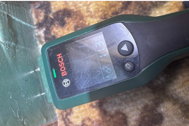
Fukt målt langs gulv 1 etasje
