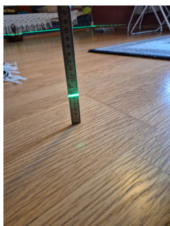
Målt store skjevheter i gulv i 2. etg.
