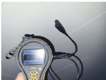
Fuktsøk med pigger. Ingen forhøyede fuktverdier påvist.
