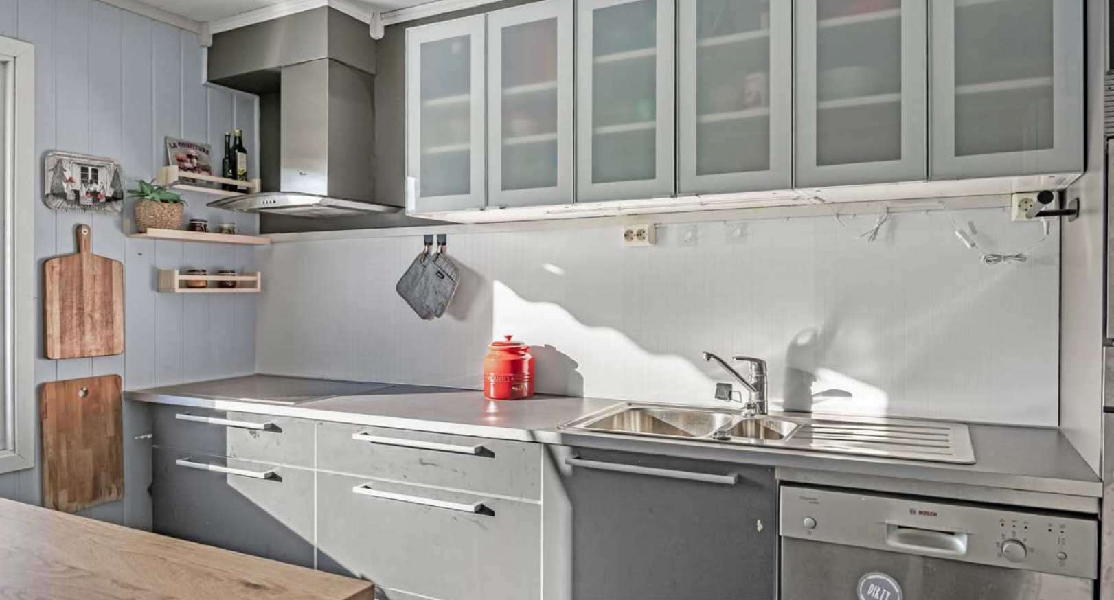
Kjøkkeninnredning fra 2019 med malte, slette fronter og laminat benkeplate med nedfelt rustfri servant med sidefelt. Det er overskap med frostet glass.
