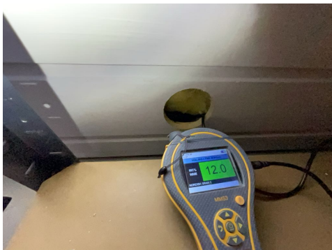
Hulltaking er foretatt i vegg fra tilstøtende vaskerom.
