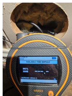
Måling av trefukt i lukket veggkonstruksjon mellom entrè og dusjsone.
