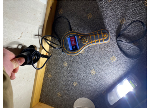
Fuktmåling foretatt med Protimeter MMS3 med pigger i bunnsvillen
