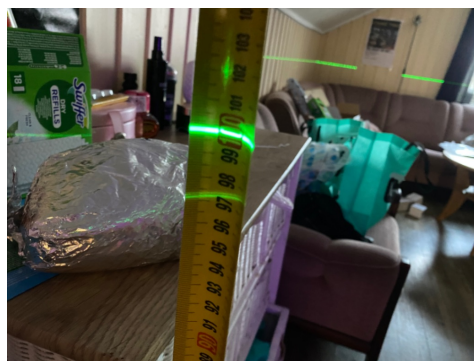
Måling av planavvik, hybel mot nord.
