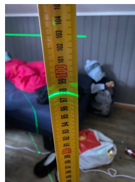
Måling av planavvik, hybel mot nord.
