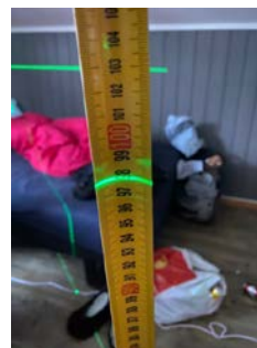
Måling av planavvik, hybel mot nord.
