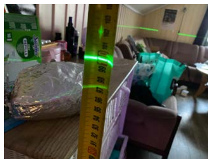
Måling av planavvik, hybel mot nord.
