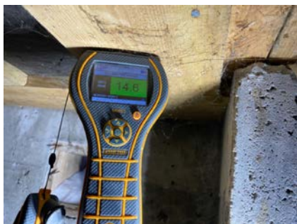
Fuktmåling viste ingen unormale forhold.
