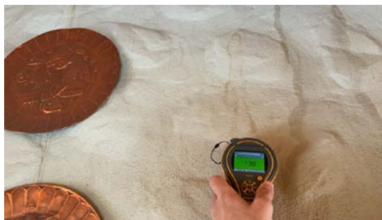
Bed fuktmåletaking var det ikke fuktutslag
