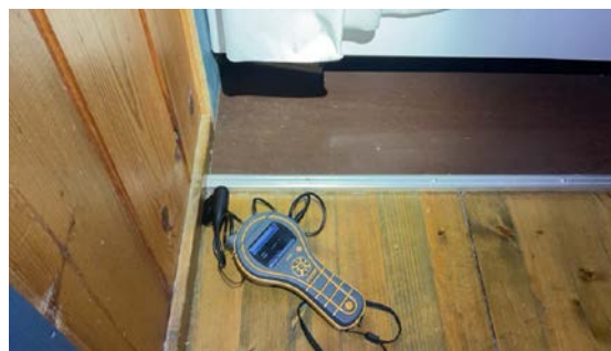
Ved fuktmåletaking av overgang vegg inne på badet er det ikke fuktutslag
