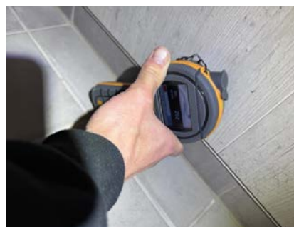
Utført fuktsøk med et protimeter MMS2. Det registreres forhøyde fuktverdier i nedre del av baderomsplater.
