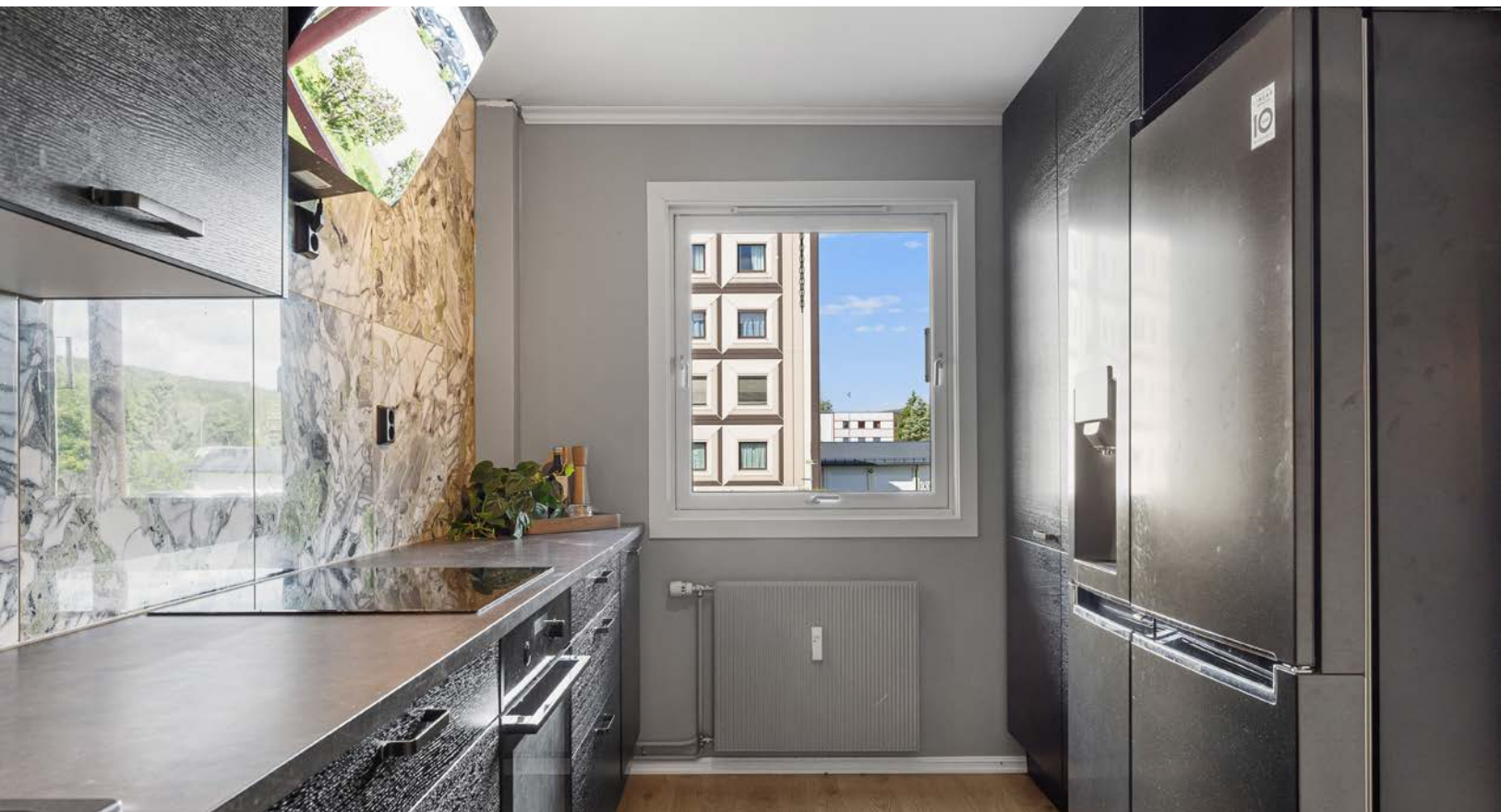
Innredningen er fra IKEA og består av over-, under- og høyskap med mørke, glatte fronter. Laminerte benkeplater med nedfelt oppvaskkum.
