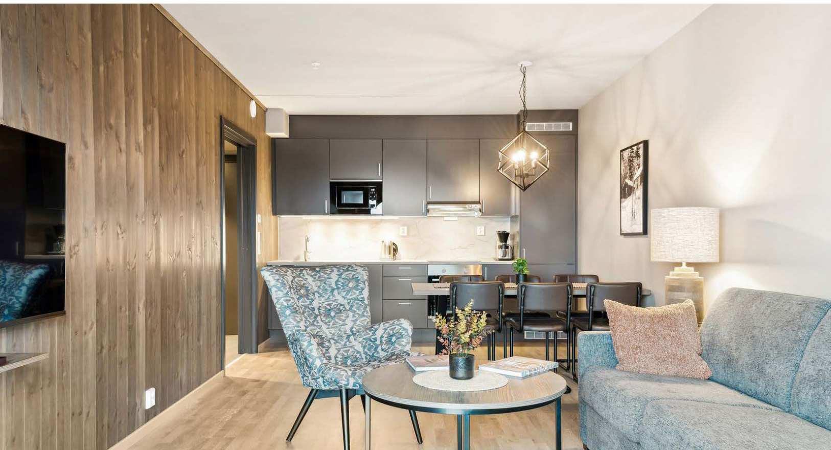
Som en kontrast til de ellers lyse overflatene med 3-stavs parkettgolv og lysmalte veggflater og himling er en stuevegg kledd med panel i lun fargetone.
